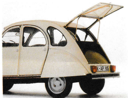
Umrüstsatz für große Heckklappe, Heckfenster schwenkt mit hoch. ZC 9867213 U
