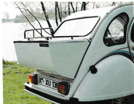
Gepäckkasten in Fahrzeugfarbe lackierbar aus Alu- minium, TÜV frei KN 23404
